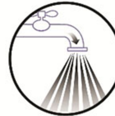
8. รอให้น้ำไหลจากก๊อกน้ำเสมอ (ประมาณ 2-3 นาที)
